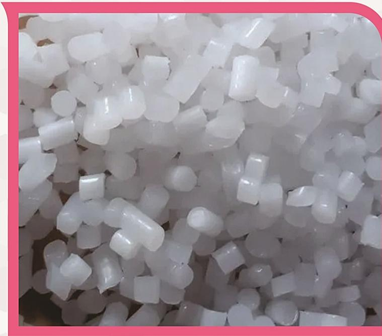
Antioksidanlar, polimerleri hem işleme sırasında (kısa vadeli stabilizasyon) hem de kullanım sırasında (uzun vadeli stabilizasyon) bozulmadan korumak için kullanılır. Polimer bozunması genellikle jel oluşumuna ve eriyik akış indeksinin değişmesine, mekanik ve estetik özelliklerin kaybolmasına (çarpma, parlaklık azalması, tebeşirlenme) ve renk bozulmasına neden olur.
